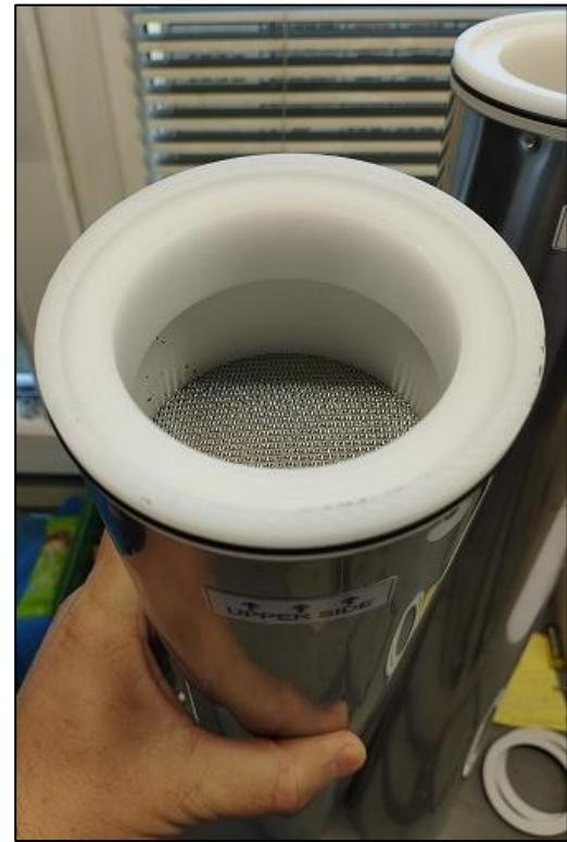
**Obr. 16: Výmena kaziet s adsorbentom**
