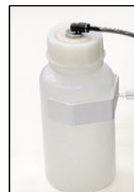
Abb. 5: Überprüfen des Kondensatauffangbehälter
