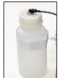
Abb. 5: Überprüfen des Kondensatauffangbehälter
