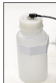
Obr. 17: Kontrola nádoby na zber kondenzátu
