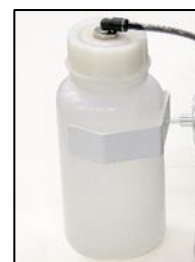
Abb. 17: Überprüfen des Kondensatauffangbehälter
