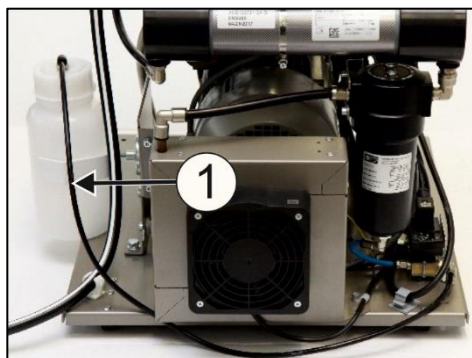
Obr. 10: Pripojenie nádoby na kondenzát
