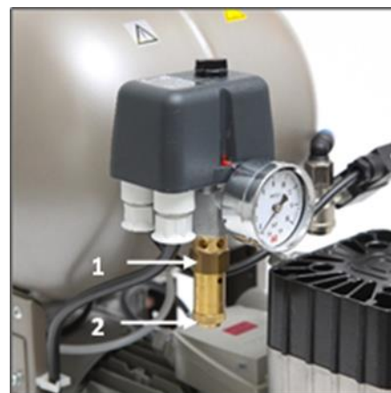
Rys. 7: Kontrola zaworu bezpieczeństwa
