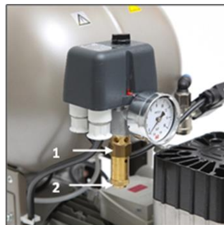
Рис. 7: Проверка предохранительного клапана
