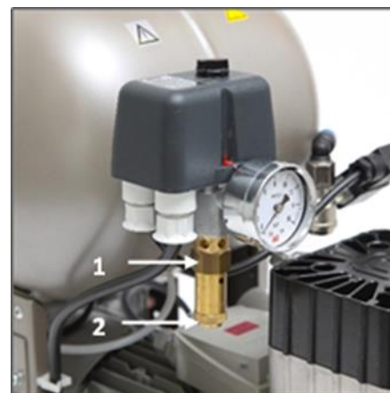
Obr. 7: Kontrola poistného ventilu
