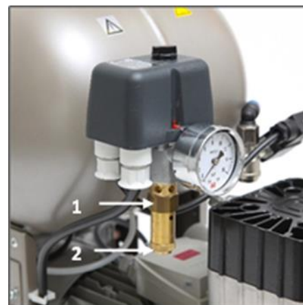
Obr. 7: Kontrola poistného ventilu
