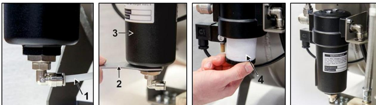
Obr. 19: Výmena filtračnej vložky vo filtri
