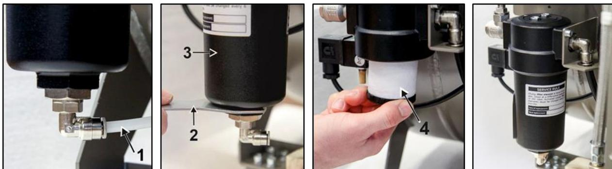
Abb. 19: Austausch des Filterelements
