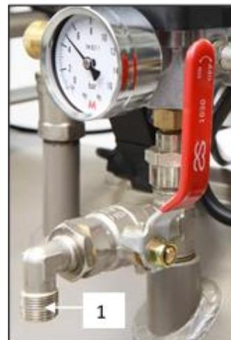
Obr. 8: Pripojenie k výstupu stlačeného vzduchu
