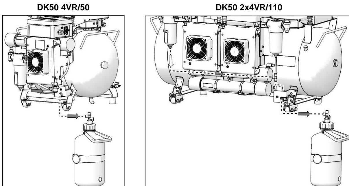
Obr. 10: Výstup kondenzátu
