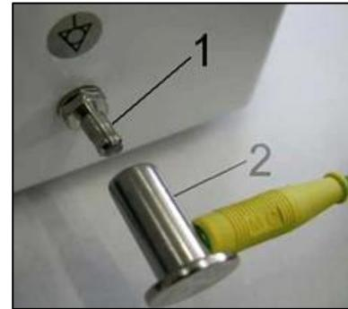
**Fig. 11 :Equipotential bonding**
