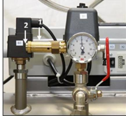
**Abb. 17: Sicherheitsventil überprüfen**
