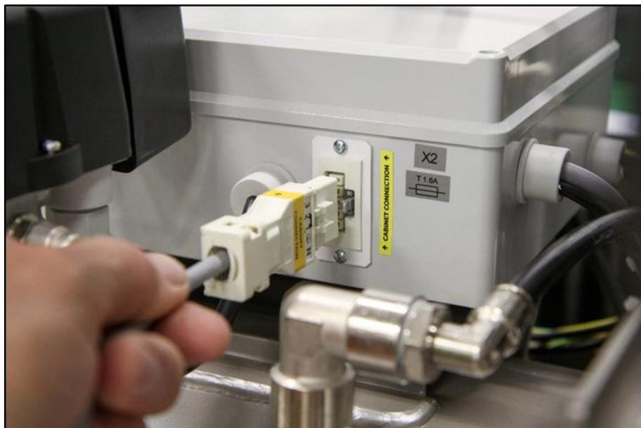
**Obr. 13: Zapojenie skrinky ku kompresoru**
