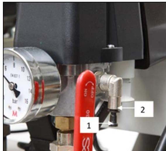
**Abb. 9: Verbinden des Gehäuse-Druckmessers mit dem Kompressor**
