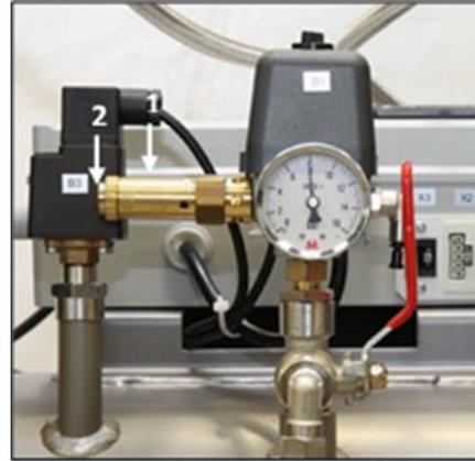
Obr. 17: Kontrola poistného ventilu
