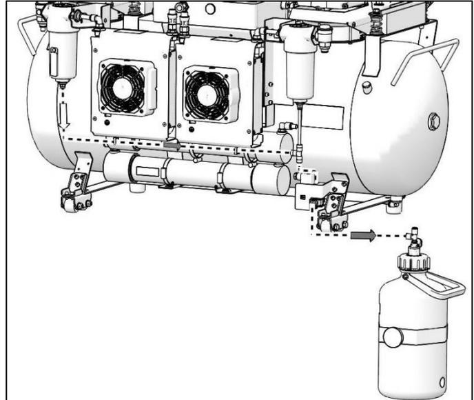
**Fig. 10: Condensate drain**
