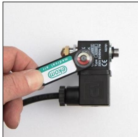
Obr. 20: Solenoidný ventil M10
