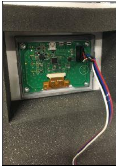
Abb. 17: Anschließen des Displaysteckers
