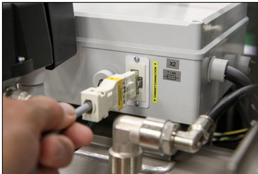
Abb. 13: Anschließen des Gehäuses an den Kompressor
