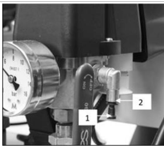
Obr. 9: Prijenie tlakomera skrinky ku kompresoru
