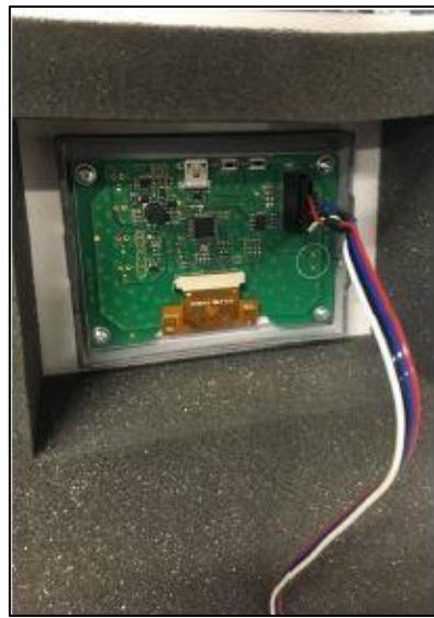
**Abb. 17: Anschließen des Displaysteckers**
