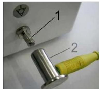
**Obr. 11: Ekvipotenciálne pospojovanie**
