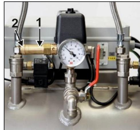
Obr. 24: Kontrola poistného ventilu
