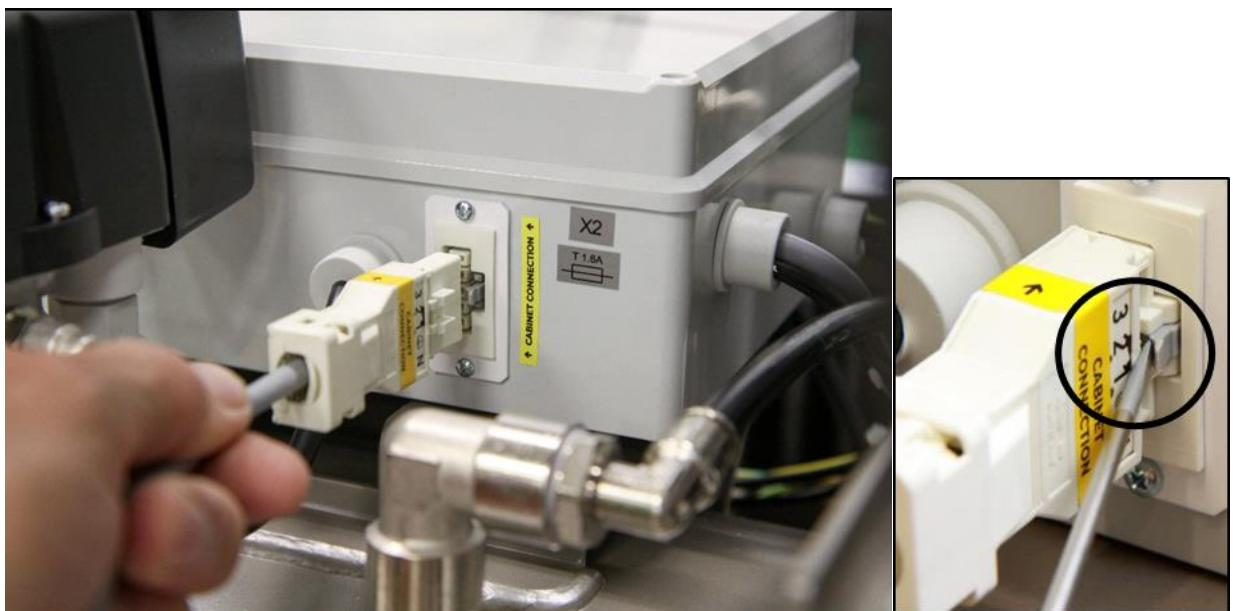
Obr. 13: Zapojenie skrinky ku kompresoru
