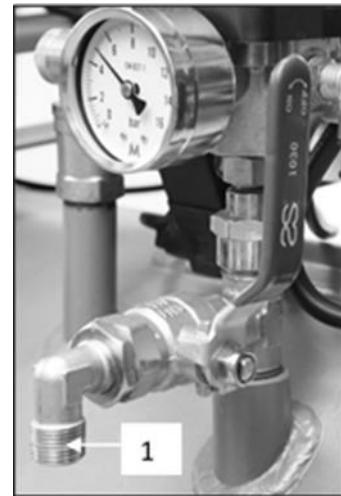
**Abb. 8: Anschluss an den Druckluftausgang**
