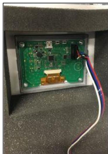
**Obr. 17: Pripojenie konektora displeja**
