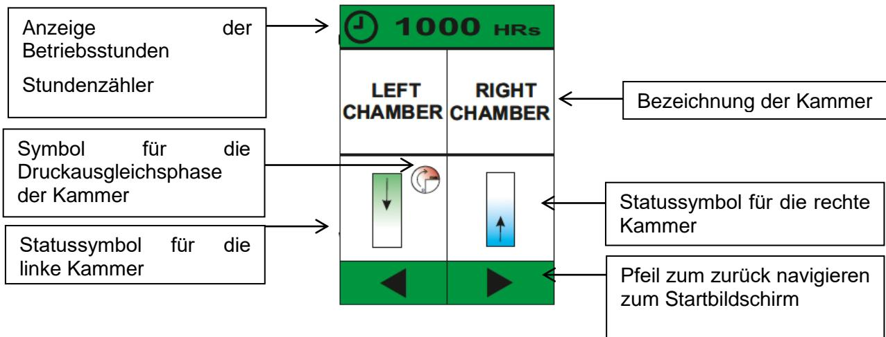
Die Anzeige der Betriebsstunden des Trockners befindet sich oben auf dem Bildschirm. Der Betriebsbildschirm des Trockners ist auch in 4 Kacheln unterteilt. Diese zeigen die Arbeitszyklen der Trocknerkammern anhand einer grafischen Darstellung der Betriebszustände der einzelnen Kammern.
