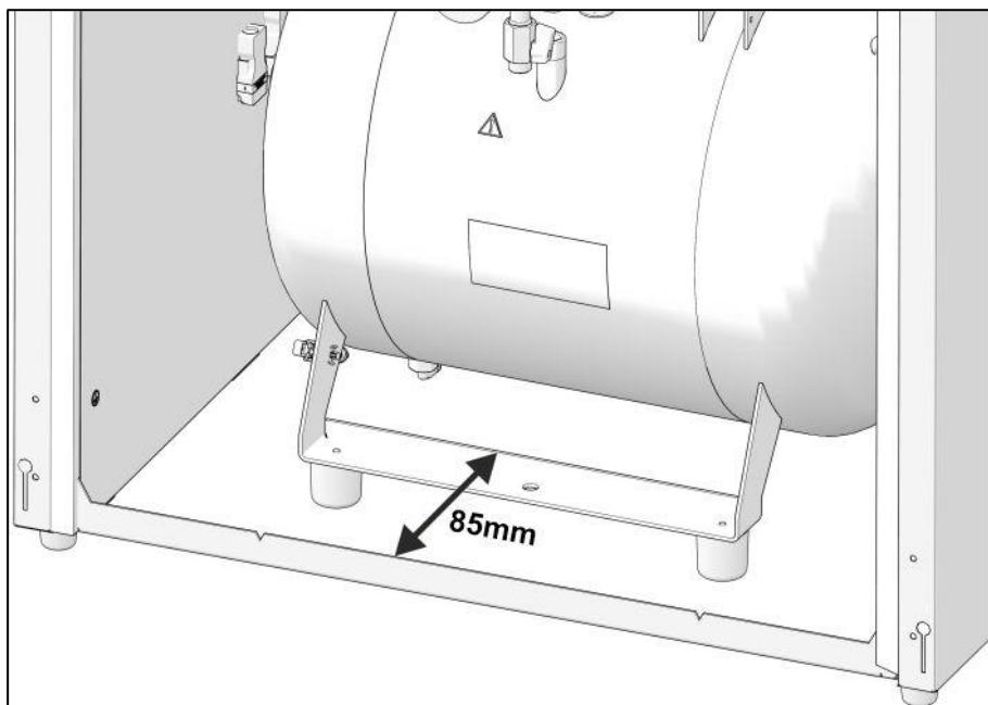
**Obr. 16: Ustavenie kompresora DK50 2V/50/M v skrinke**
