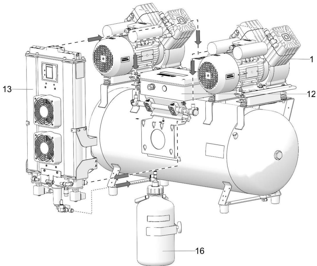
**Abb. 3: Adsorptionstrockner**
