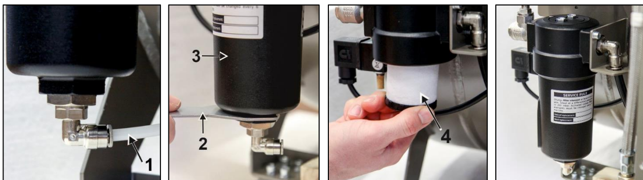
Obr. 18: Výmena filtračnej vložky vo filtri
