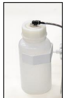
Abb. 15: Überprüfen des Kondensatauffangbehälter
