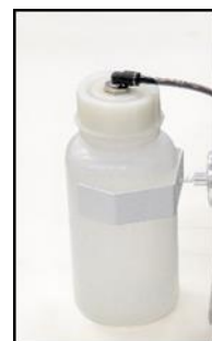
Obr. 15: Kontrola nádoby na zber kondenzátu
