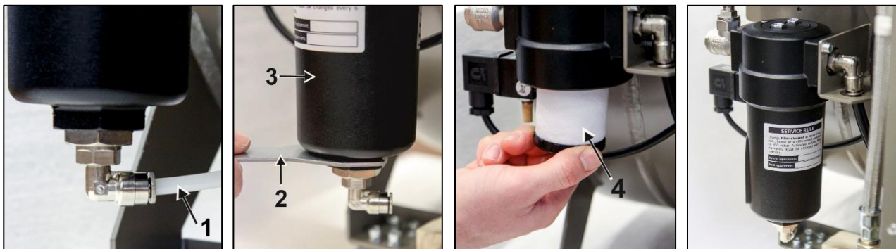
Obr. 18: Výmena filtračnej vložky vo filtri
