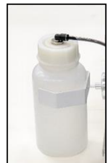
Abb. 15: Überprüfen des Kondensatauffangbehälter
