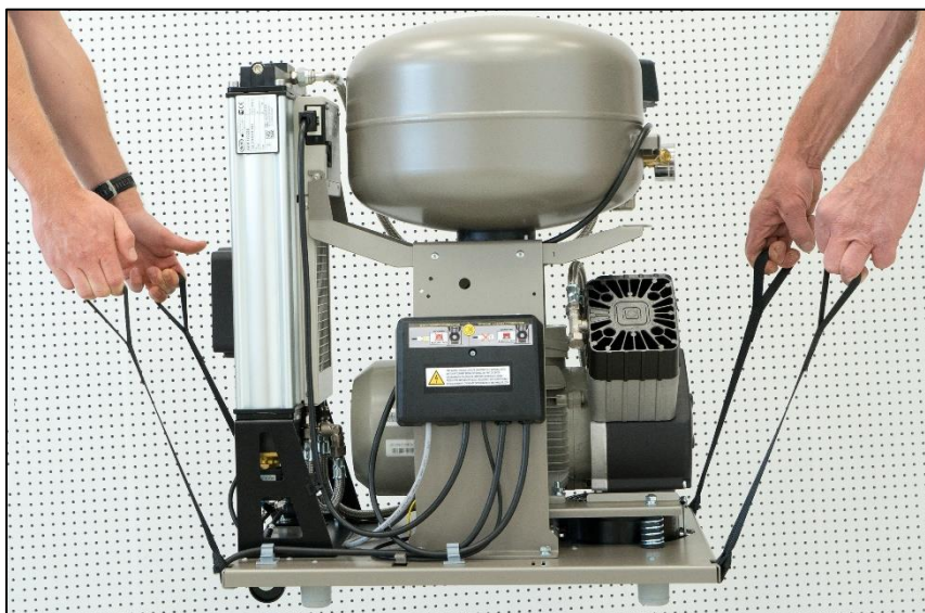
Obr. 4 :Manipulácia s kompresorom pomocou popruhov
