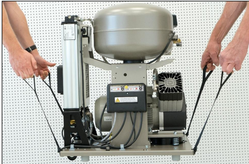
Abb. 4: Handhabung des Kompressors mittels Tragegurten
