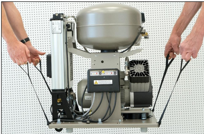
Obr. 4 :Manipulácia s kompresorom pomocou popruhov
