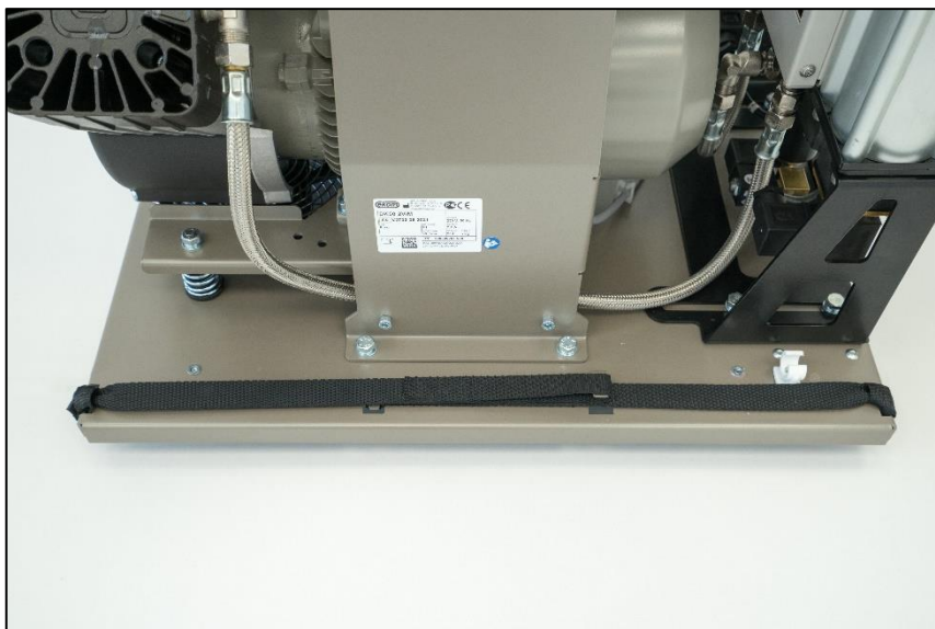
Zaistenie popruhov po ustavení kompresora
