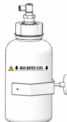
Obr. 18: Kontrola nádoby na kondenzát
