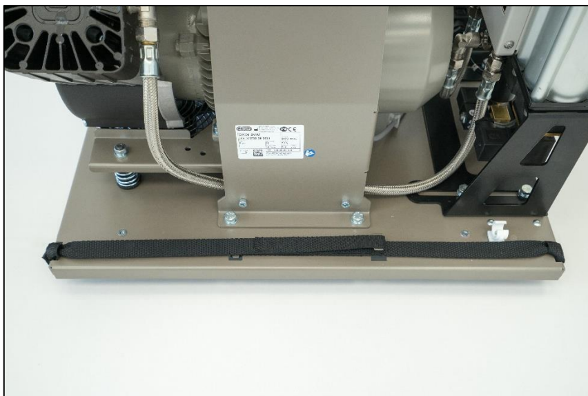
Zaistenie popruhov po ustavení kompresora
