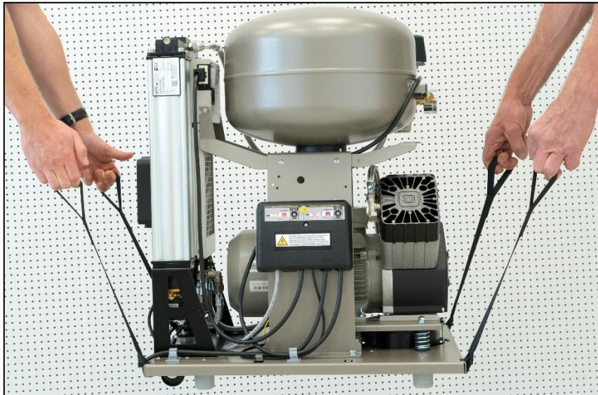
Obr. 4 :Manipulácia s kompresorom pomocou popruhov
