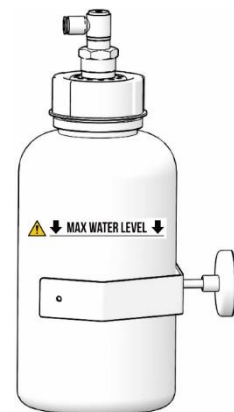
Abb. 18: Überprüfen des Kondensatauffangbehälter
