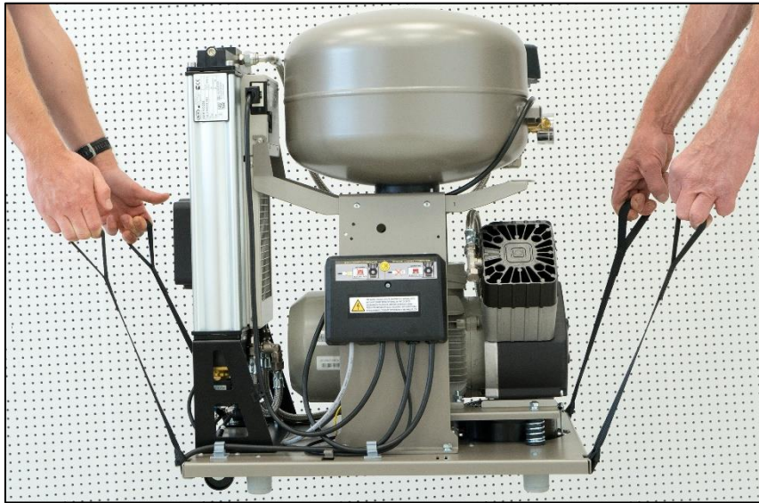
Abb. 4: Handhabung des Kompressors mittels Tragegurten
