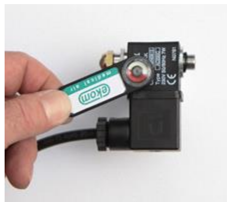
Рис. 28: Проверка работы электромагнитного клапана
