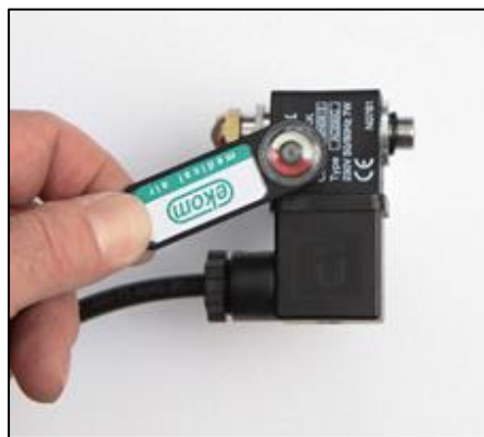
Рис. 19: Проверка работы электромагнитного клапана
