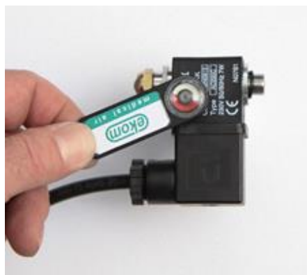
Рис. 24: Проверка работы электромагнитного клапана
