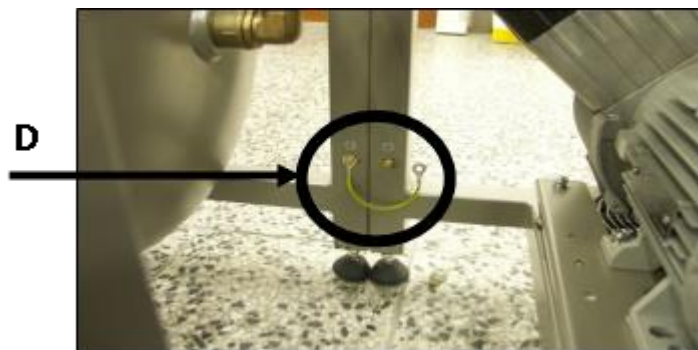
Рис. 16: Подключение проводников защитного заземления
