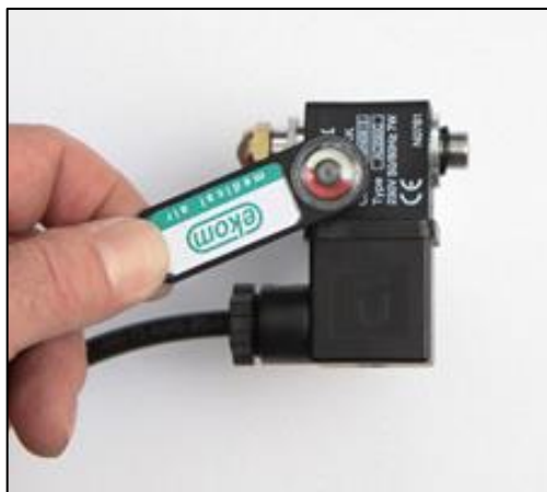
Obr. 32: Kontrola solenoidného ventilu
