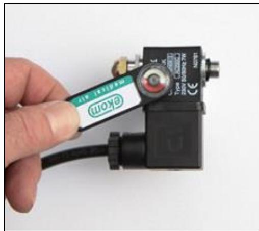
Obr. 32: Kontrola solenoidného ventilu
