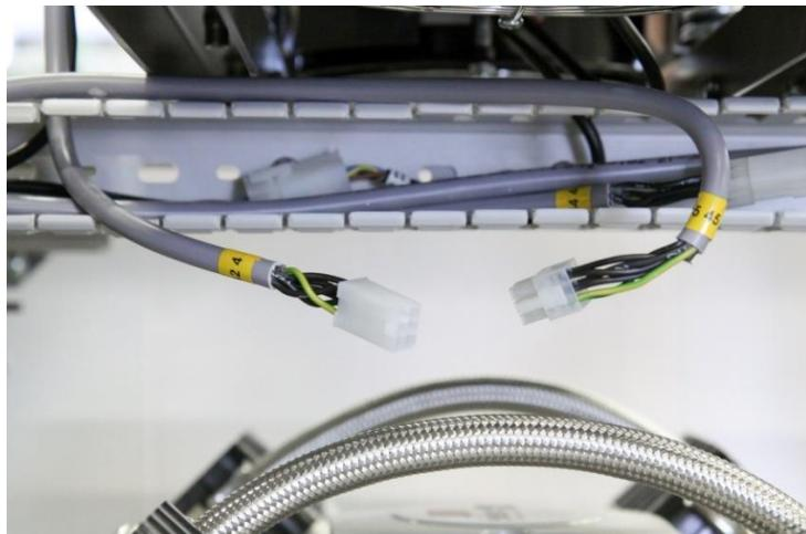
**Obr. 8: Ochranné prepojenie rámov**
