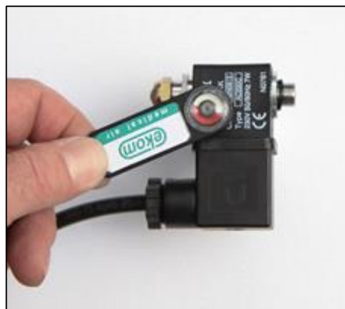
Рис. 32: Проверка работы электромагнитного клапана
