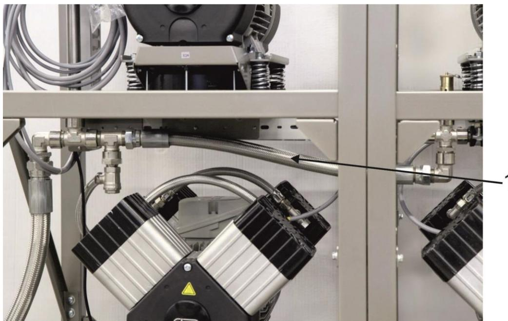
**Рис. 12: Подключение модулей компрессора**
