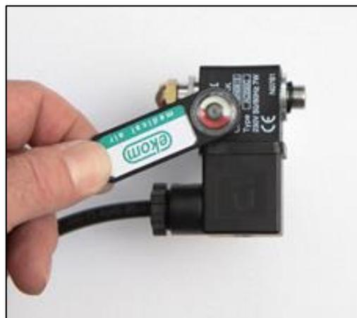
Рис. 32: Проверка работы электромагнитного клапана
