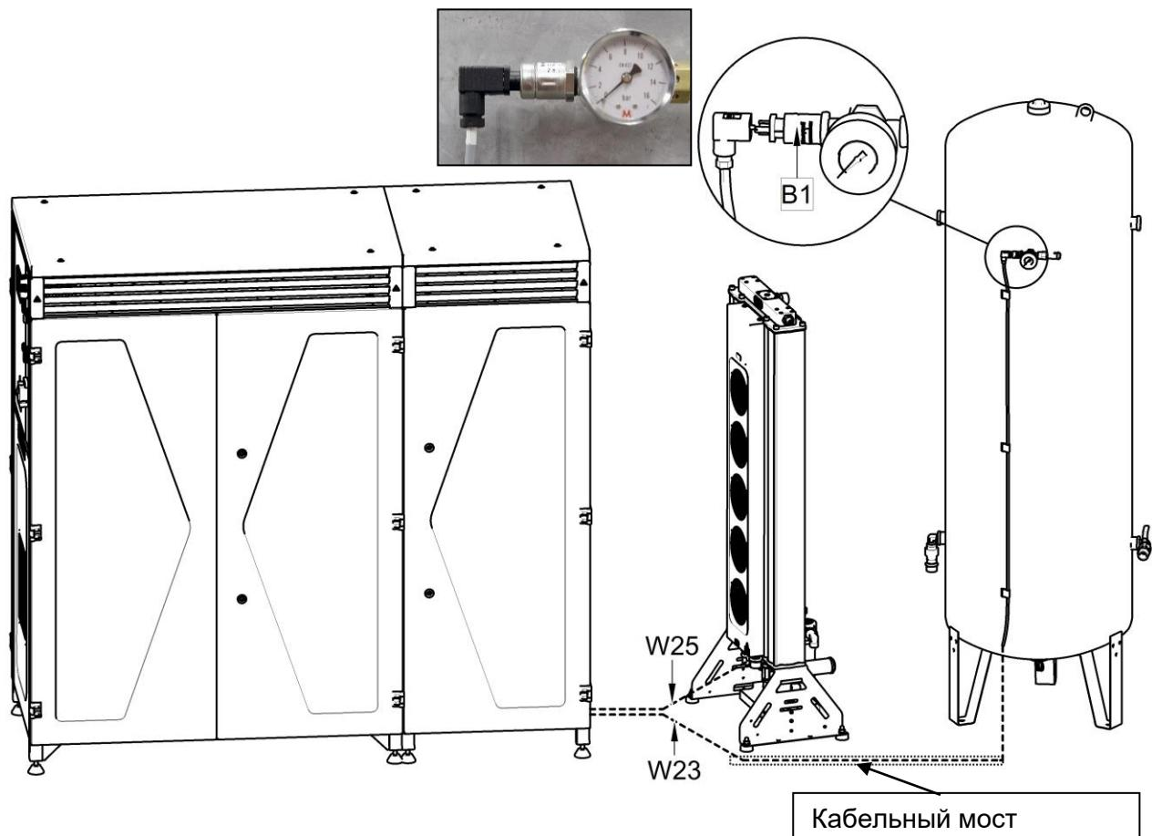
**Рис. 22: Электрический кабель**
