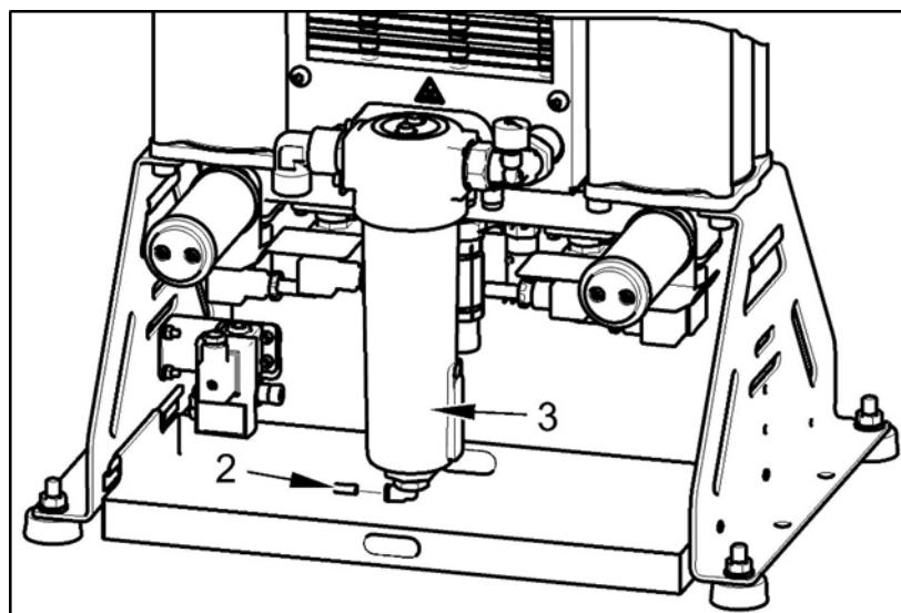
**Рис. 35: Стравливание давления из охладителя и отделителя конденсата**
