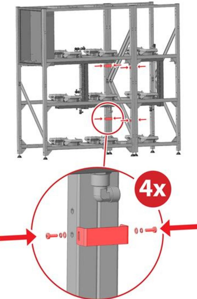
**Рис. 6: Монтаж рамы**
