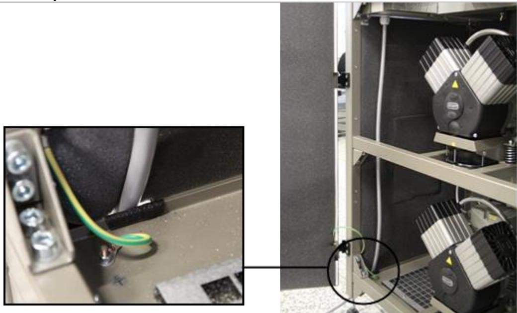
**Рис. 23: Подключение шнура питания**
