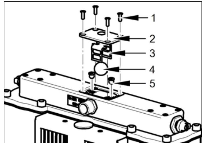
Рис. 38: Замена шарика логического клапана
