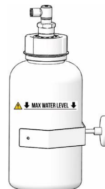
Abb. 10: Überprüfen des Kondensatauffangbehälters
