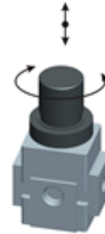
Abb. 15: Einstellung des Ausgangsdrucks
