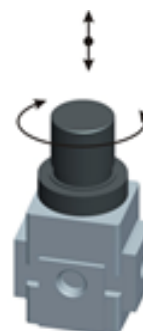
Obr. 15: Nastavenie výstupného tlaku
