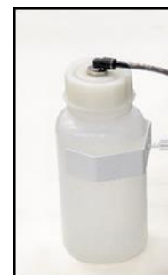
Obr. 11: Kontrola nádoby na zber kondenzátu
