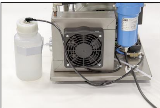
Obr. 7: Pripojenie nádoby na zber kondenzátu
