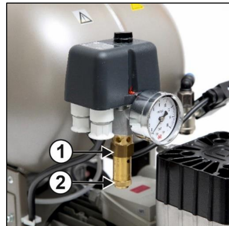
Obr. 13: Kontrola poistného ventilu
