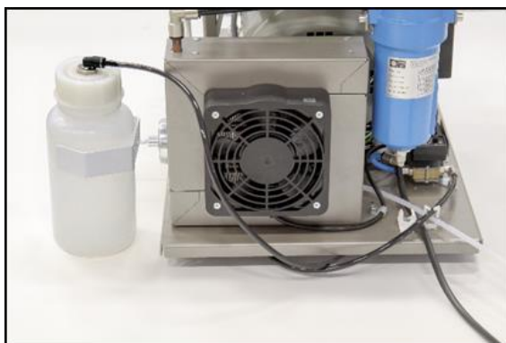
Abb. 7: Anschluss des Kondensatauffangbehälter
