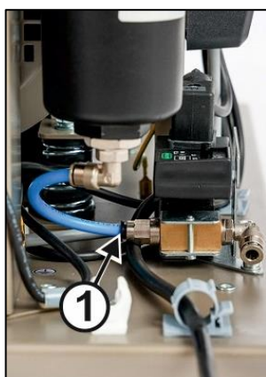
Obr. 15: Výmena filtračnej vložky vo filtri
