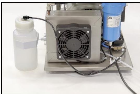
Obr. 7: Pripojenie nádoby na zber kondenzátu
