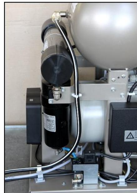
**Obr. 6: Pripojenie k výstupu stlačeného vzduchu**
