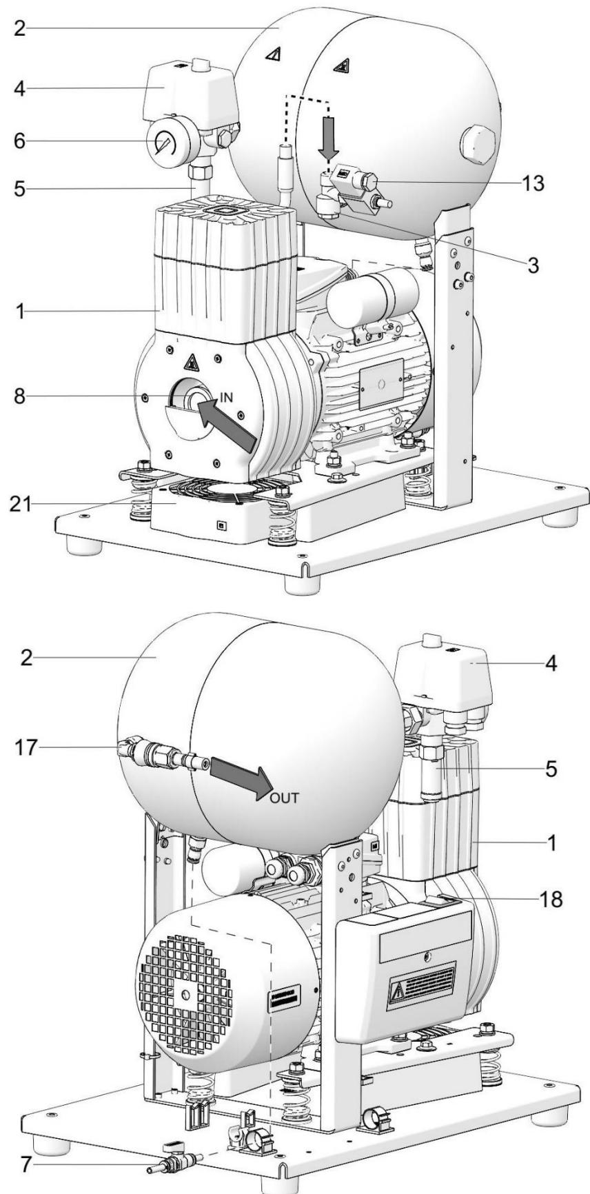
Obr. 2: DK50-10Z/M - Kompresor so sušičom
