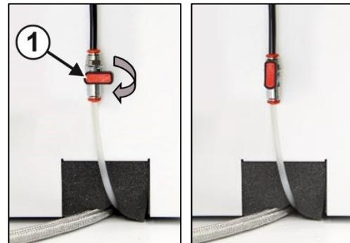
**Obr. 10: Vypustenie kondenzátu z tlakovej nádoby**
