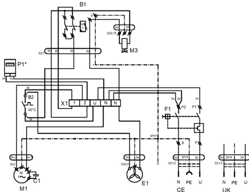
P1\* – Stundenzähler nur für das Kompressormodell mit 8 bis 10 bar installiert
