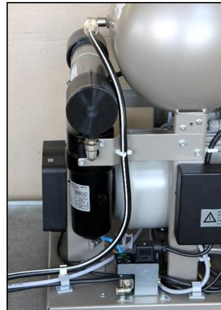
Abb. 6: Anschluss an den Druckluftausgang
