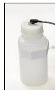
Abb. 11: Überprüfen des Kondensatauffangbehälter
