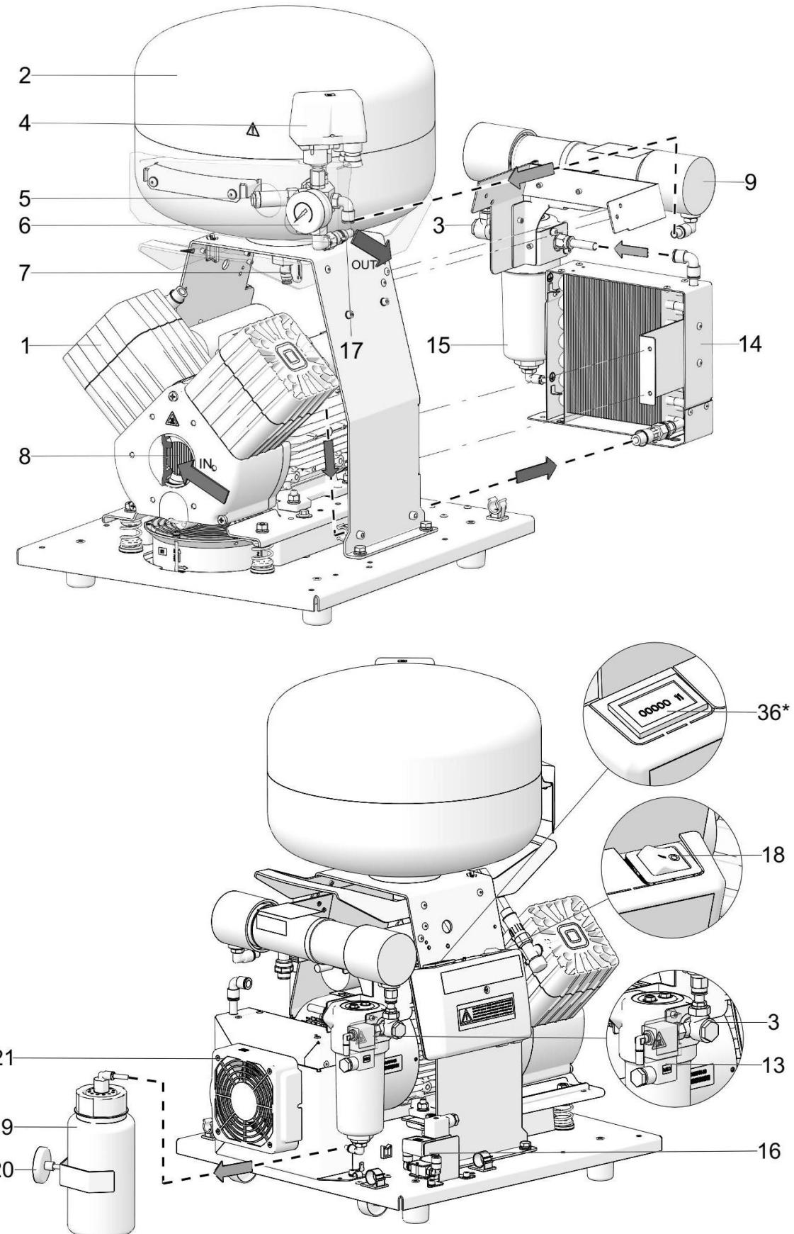
\* Stundenzähler nur für das Kompressormodell mit 8 bis 10 bar installiert.
