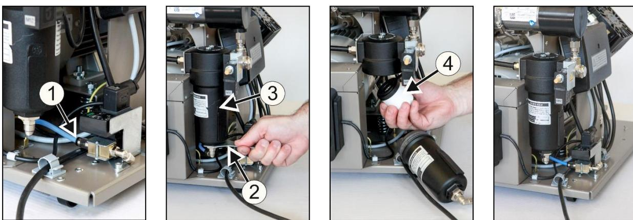
**19.9. Kontrola chladiče a ventilátoru (Obr. 2)**
