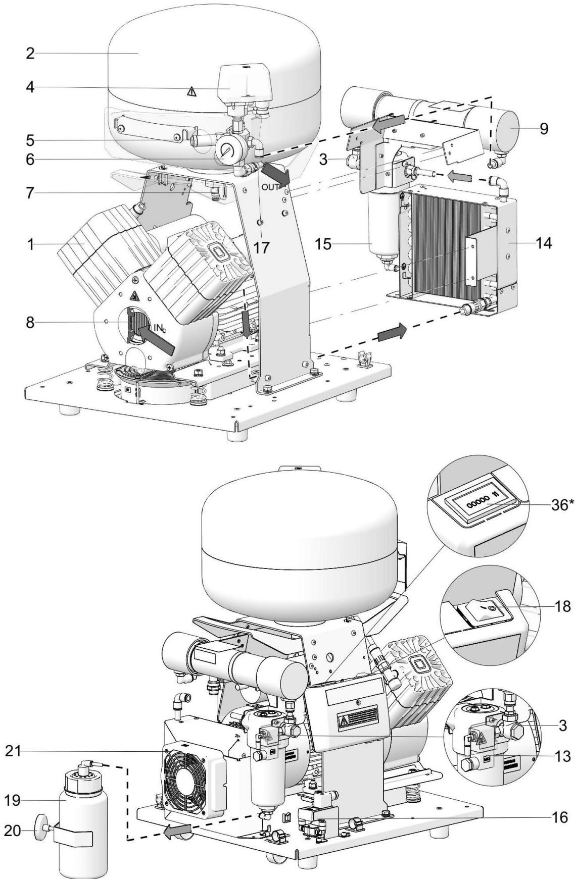
\* Часометром оборудована только модель компрессора с давлением 8–10 бар.
