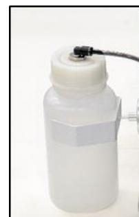
Rys. 16: Sprawdź poziom kondensatu w naczyniu
