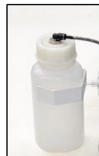
**Рис. 16: Проверка резервуара для сбора конденсата**
