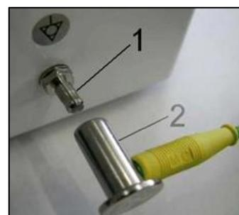
Obr. 9: Ekvipotenciálne pospojovanie
