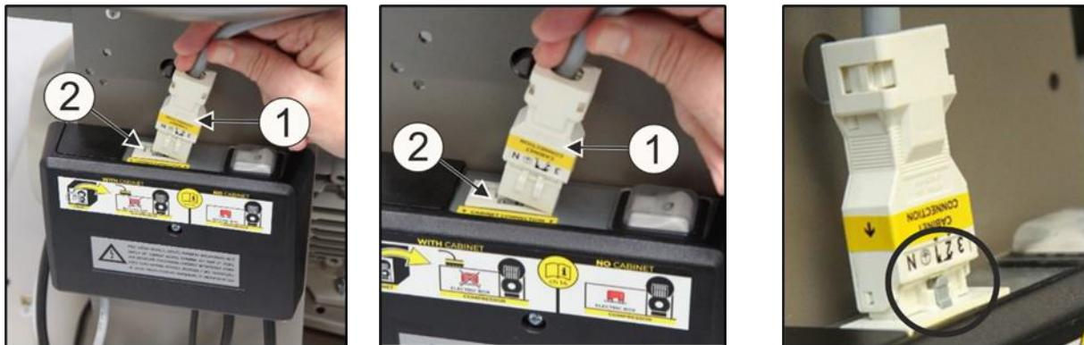
**14. POSITIONNEMENT DU COMPRESSEUR DANS L'ARMOIRE**
