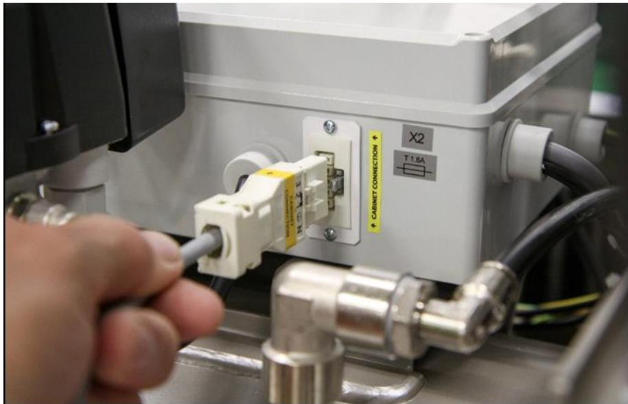
Rys. 13: Podłączanie obudowy do sprężarki
