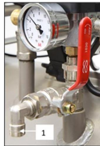
Abb. 8: Anschluss an den Druckluftausgang
