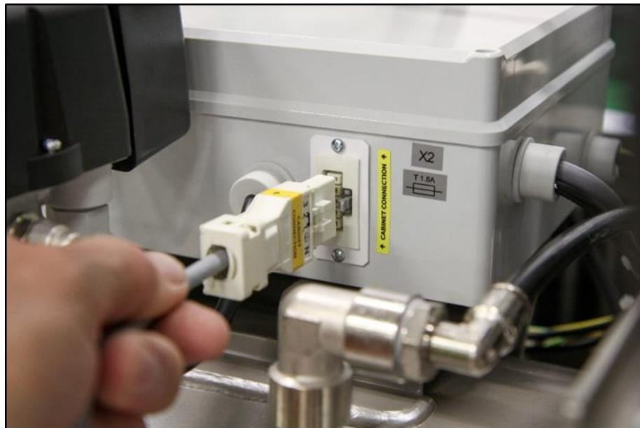
**Fig. 13: Raccordement de l'armoire au compresseur**
