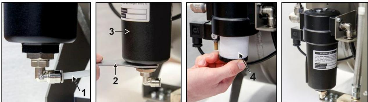
**Fig. 19: Remplacement de l'élément filtrant**
