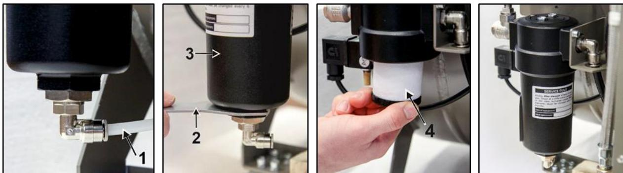
Obr. 19: Výměna filtrační vložky ve filtru
