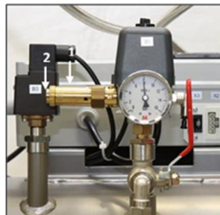
Obr. 17: Kontrola pojistného ventilu
