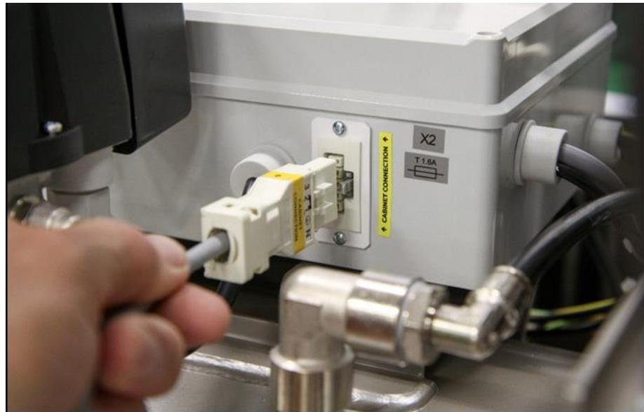
Obr. 13: Zapojenie skrinky ku kompresoru
