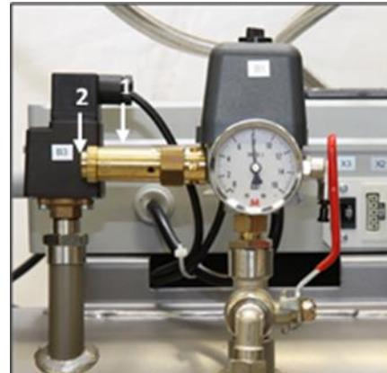
Abb. 17: Sicherheitsventil überprüfen
