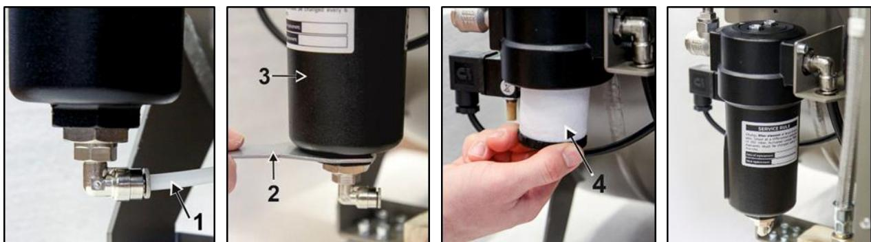
Рис. 19: Замена фильтрующего элемента
