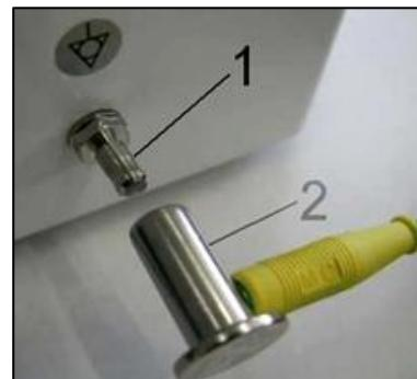
Obr. 11: Ekvipotenciálne pospojovanie
