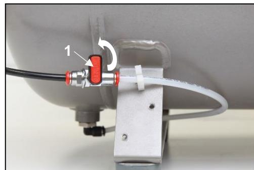
Obr. 15: Vypuštění kondenzátu
