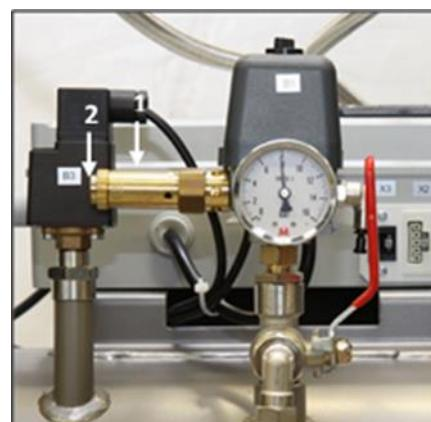
Rys. 17: Kontrola zaworu bezpieczeństwa
