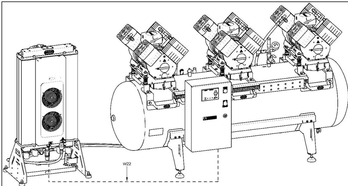
Obr. 14: Pripojenie riadiaceho signálu
