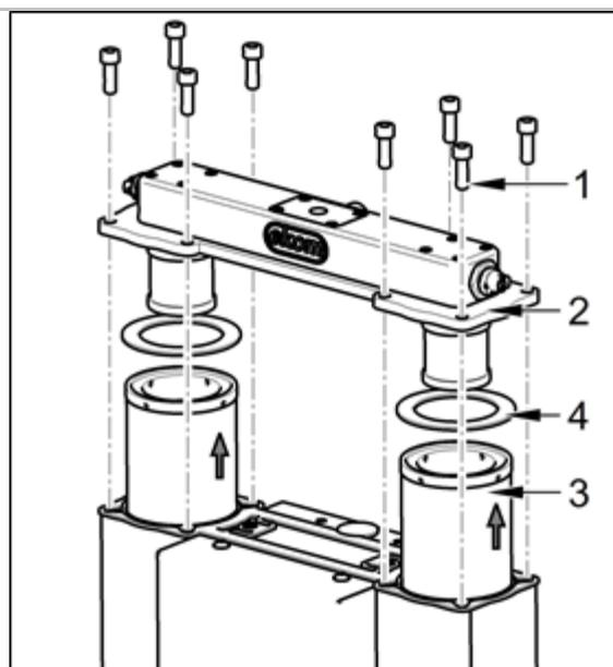
Obr. 24: Výmena kaziet s adsorbentom
