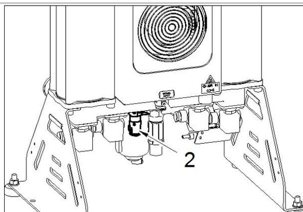
Obr. 29: Pretlakový ventil
