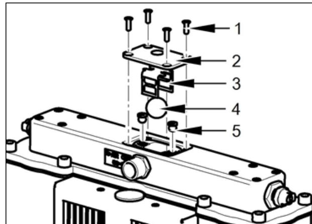
Рис. 25: Замена шарика логического клапана
