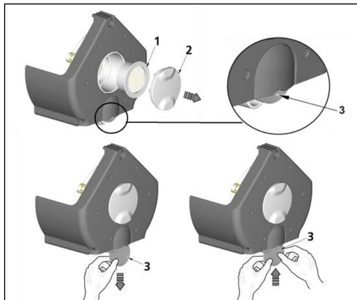
**Рис. 18: Замена всасывающего фильтра**
