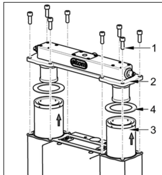
**Рис. 24: Замена кассет с адсорбентом**
