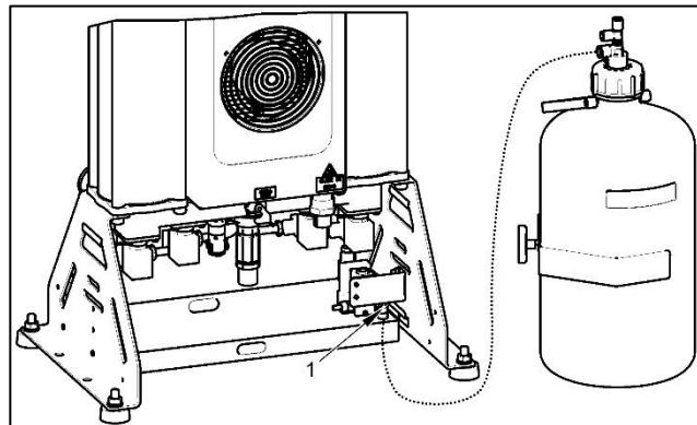
**Рис. 17: Проверка резервуара для сбора конденсата**
