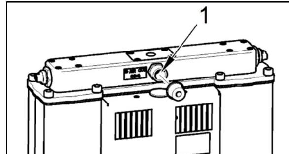
Рис. 10: Выход сжатого воздуха
