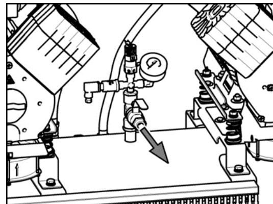
Рис. 11: Выход воздуха из ресивера
