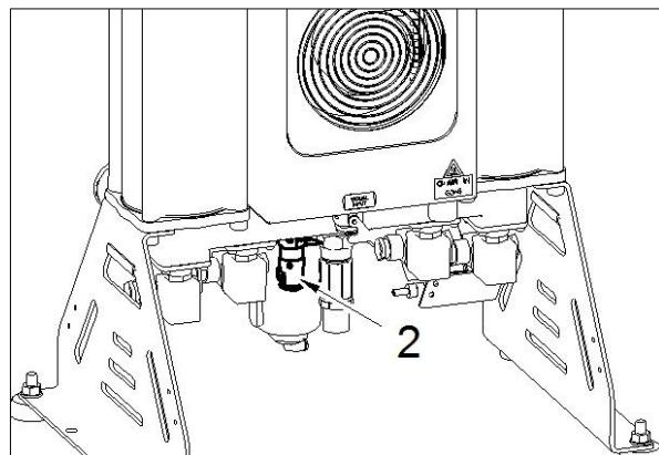
Рис. 29: Клапан сброса избыточного давления
