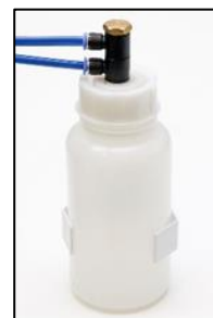
Abb. 18: Überprüfen des Kondensatauffangbehälter
