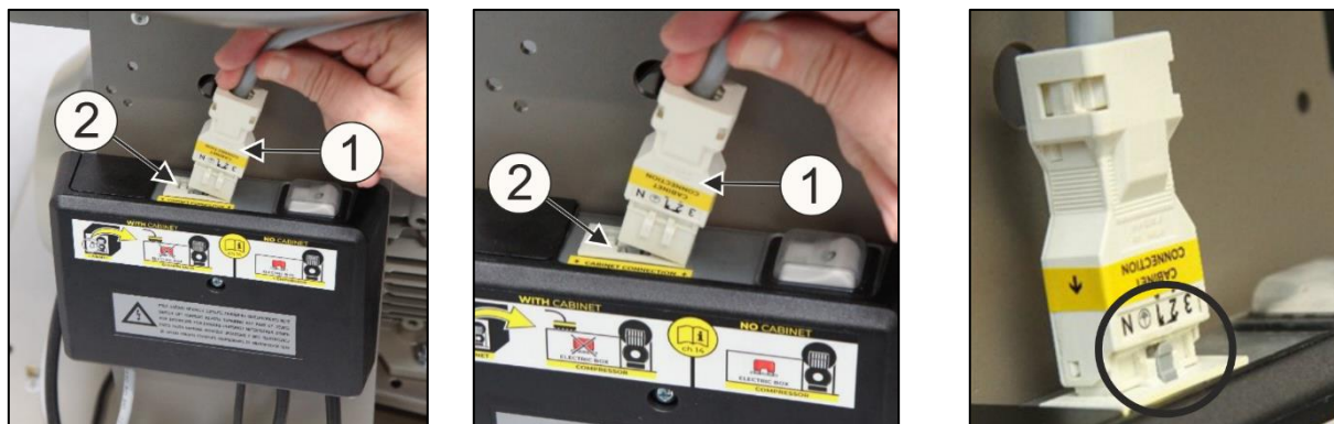
Рис. 11: Подключение шкафа к компрессору
