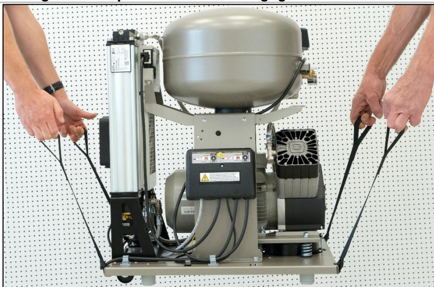
Abb. 4: Handhabung des Kompressors mittels Tragegurten
