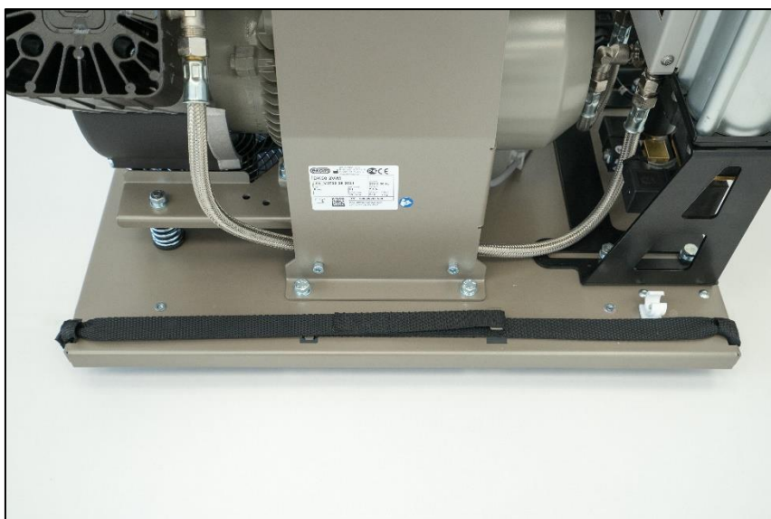
Zajištění popruhů po ustavení kompresoru
