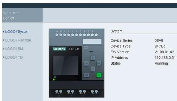
Нажмите кнопку «LOGO! TD» в браузере, чтобы отобразить текущий виртуальный статус внешнего текстового дисплея TDE. Элементы управления виртуального дисплея (функциональные кнопки и клавиши со стрелками) не отличаются от элементов управления физического дисплея.
