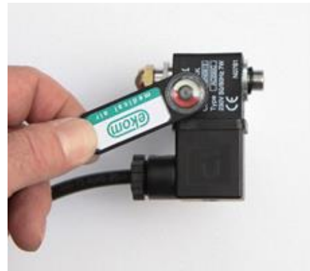
Obr. 28: Kontrola solenoidného ventilu
