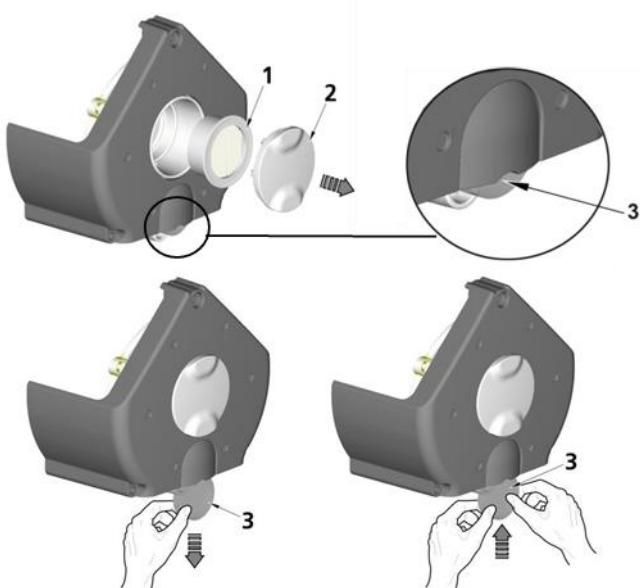
Рис. 24: Замена всасывающего фильтра
