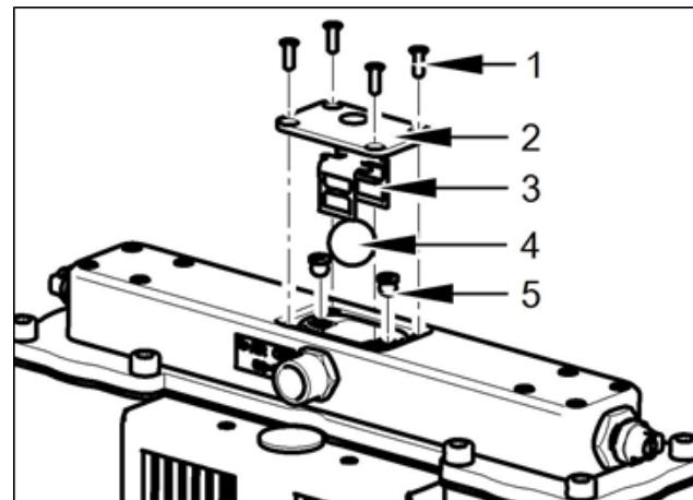
Рис. 34: Замена шарика логического клапана
