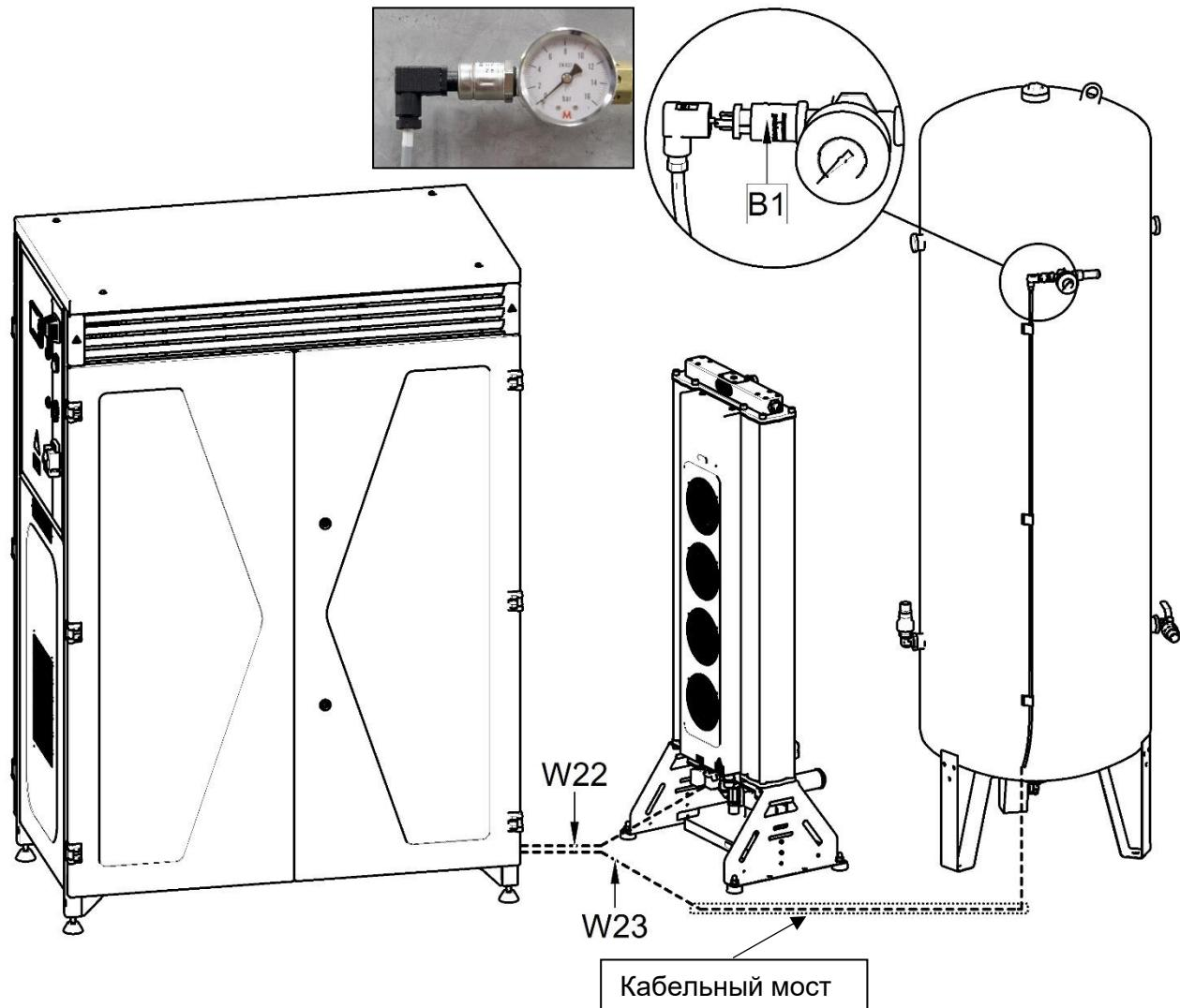
Рис. 18: Электрический кабель
