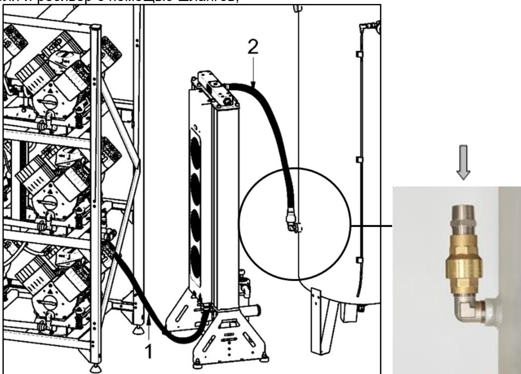
**Рис. 9: Соединение модуля компрессора, осушителя и ресивера**
