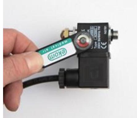
Рис. 28: Проверка работы электромагнитного клапана
