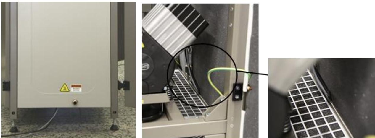
Рис. 16: Подключение к цепи сигнала управления
