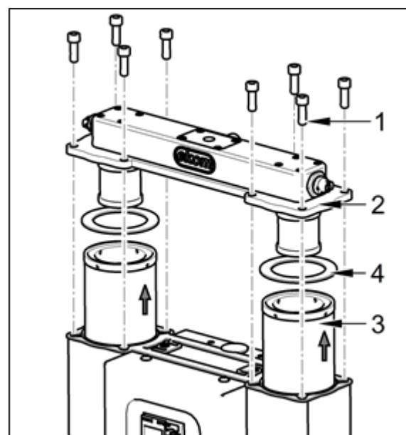
**Рис. 33: Замена кассет с адсорбентом**
