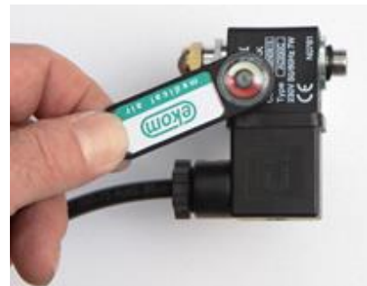
Рис. 28: Проверка работы электромагнитного клапана
