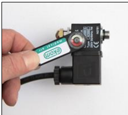
Obr. 19: Kontrola solenoidného ventilu
