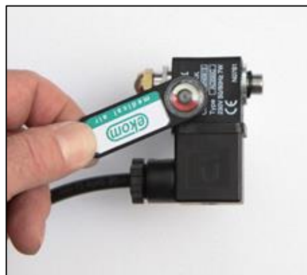
Рис. 19: Проверка работы электромагнитного клапана
