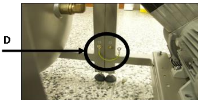
Рис. 12: Подключение проводников защитного заземления
