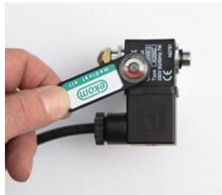
Obr. 24: Kontrola solenoidného ventilu
