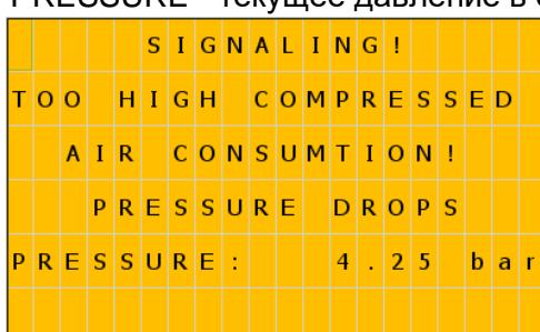
Как только давление воздуха поднимается выше 5 бар, сообщение на дисплее автоматически исчезает.
