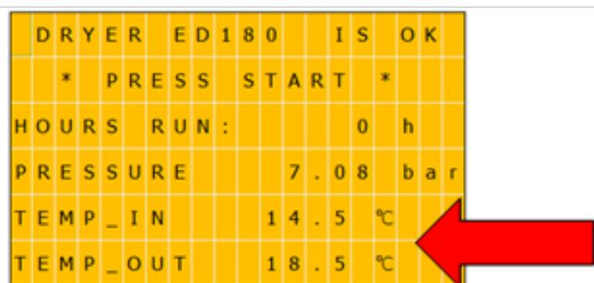
Проверка выполняется при незначительном изменении температуры вокруг датчика в результате нагрева, если значения температуры на дисплее не изменились. В моделях без корпуса датчик В4 не используется, и на дисплее отображается значение «N/A».
