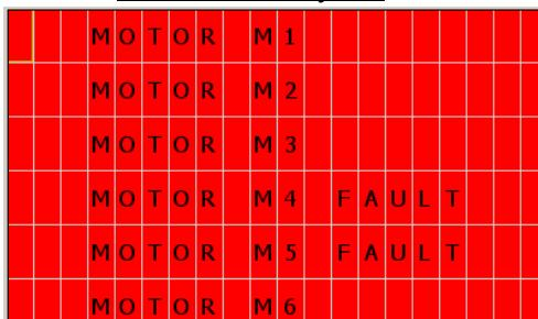
На дисплее появляется сообщение (FAULT), и начинает мигать индикатор P2-ALARM (17), указывающий на то, что агрегат не работает (прерыватель цепи двигателя (Q1-Q9) отключился из-за перегрузки по току). Дисплей мигает красным цветом. Другие агрегаты работают нормально.
