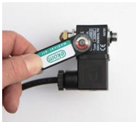
Рис. 23: Проверка работы электромагнитных клапанов
