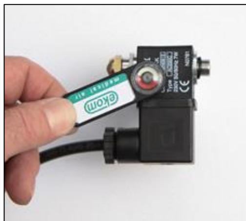
Рис. 32: Проверка работы электромагнитного клапана
