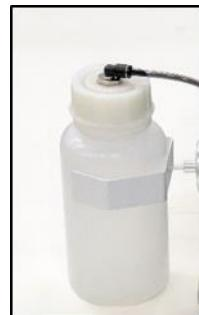
**Rys. 10: Sprawdź poziom kondensatu w naczyniu**
