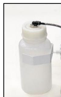
**Рис. 10: Проверка резервуара для сбора конденсата**
