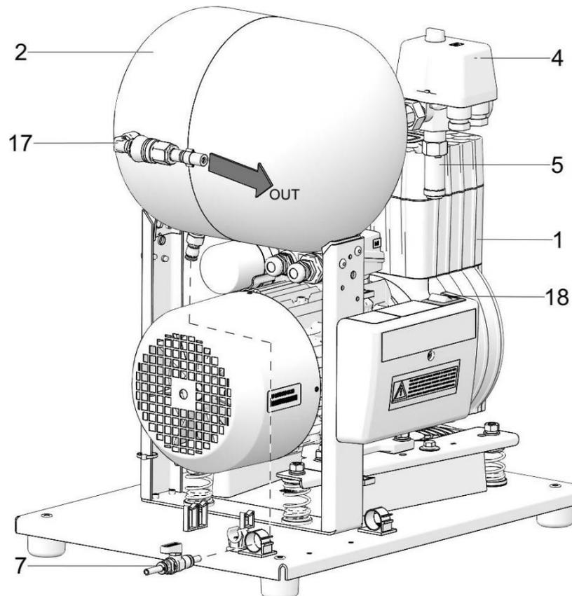
Fig. 2: DK50-10Z/M - Compresseur avec sécheur
