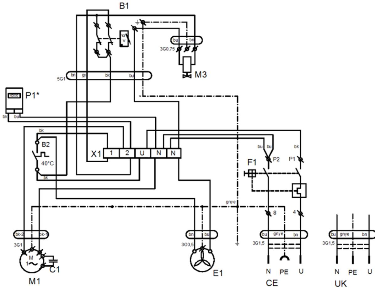
P1\* - Horomètre installé uniquement pour le modèle de compresseur 8-10 bars
