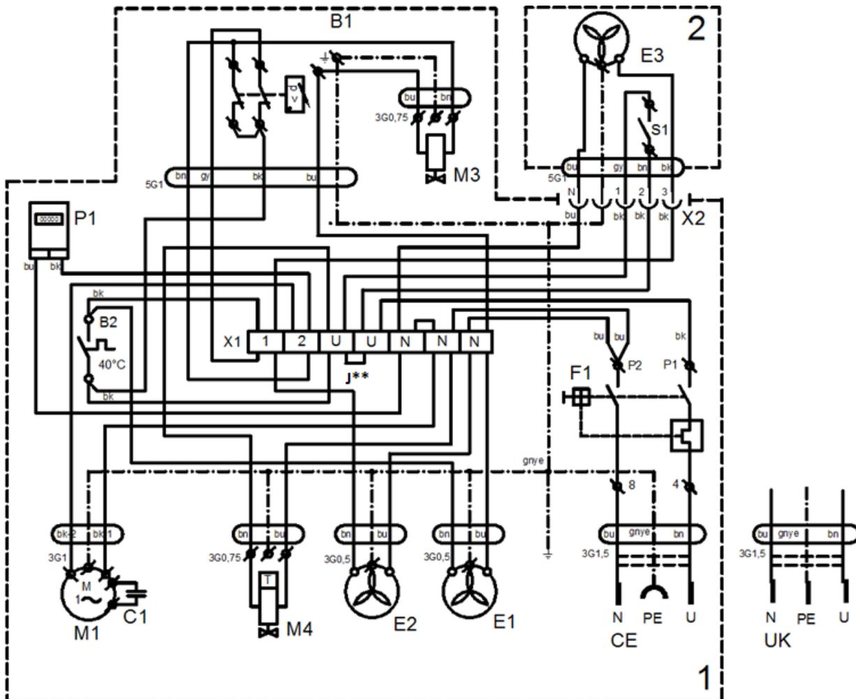
J\*\* - перемычка устанавливается только для моделей компрессоров, не устанавливаемых в шкаф (глава 19.10)
