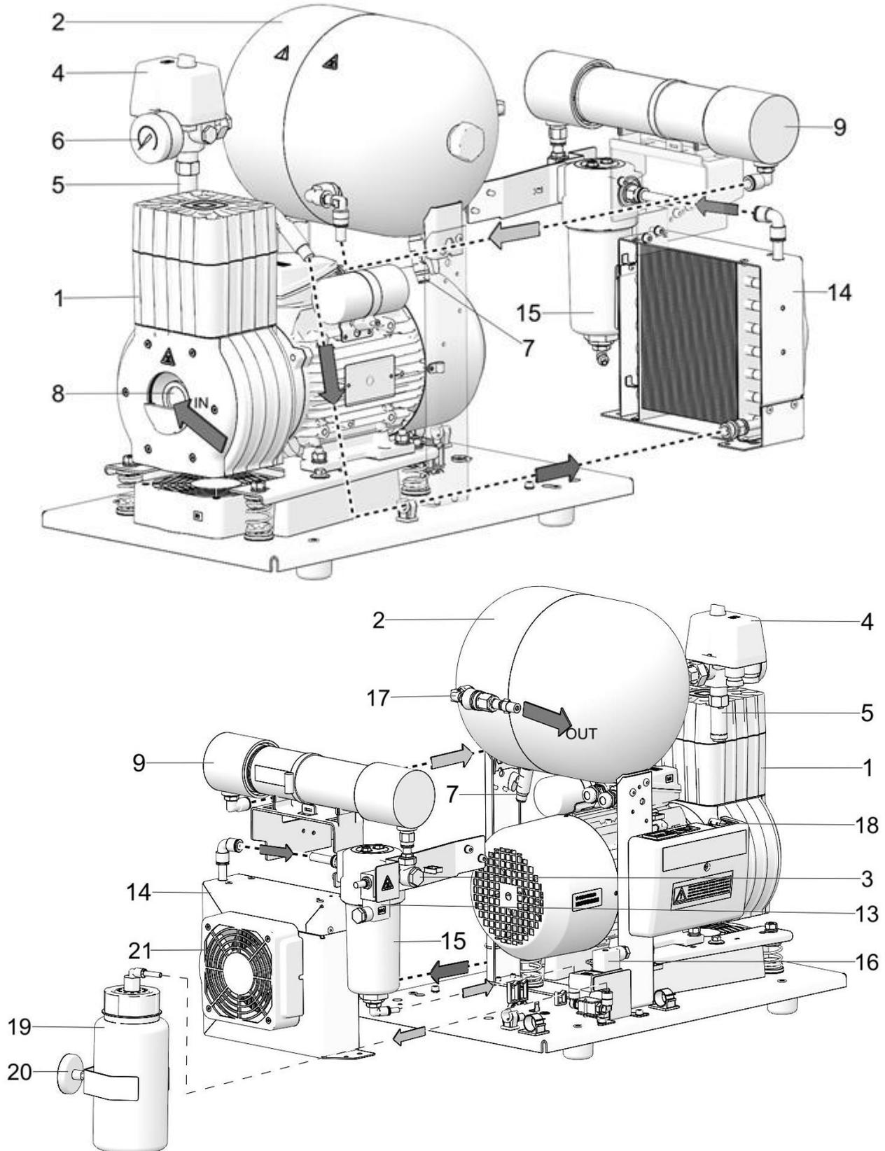
Fig. 3: Compresseur DK50-10 S/M (8-10bar)
