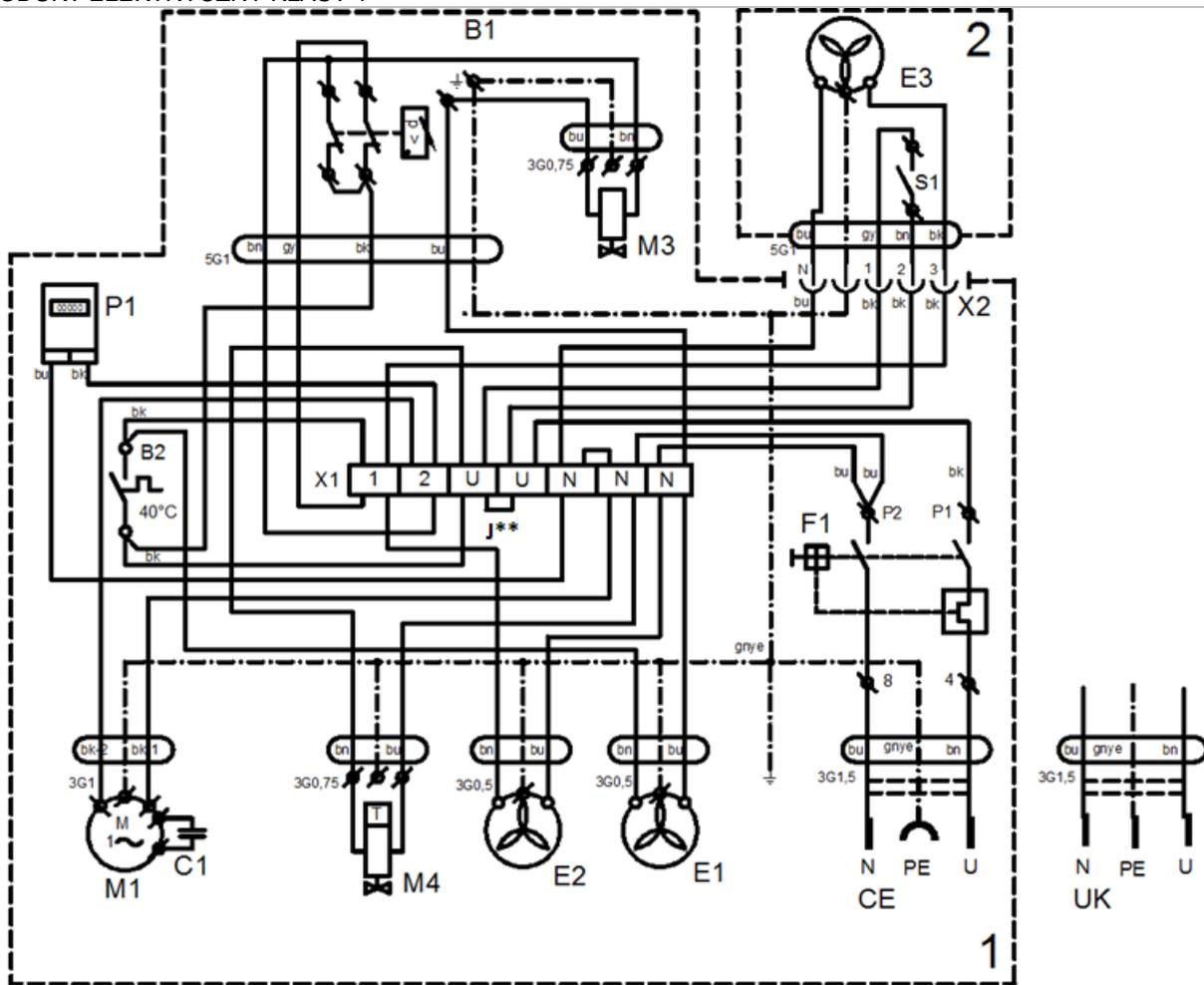
J\*\* - Łącznik podłączać tylko w modelach sprężarek niemontowanych w obudowie (rozdz. 19.10)
