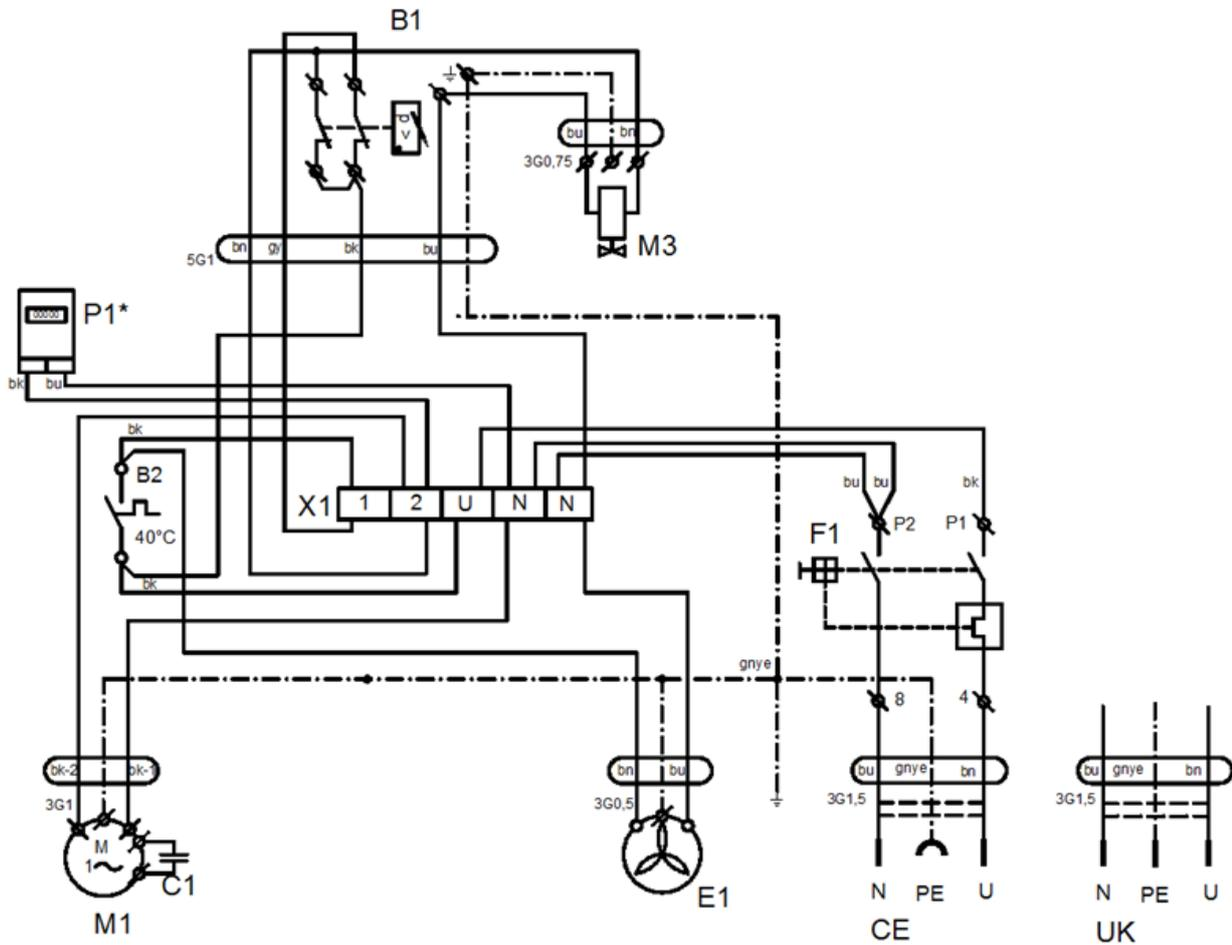
P1\* - часомером оборудована только модель компрессора с давлением 8–10 бар
