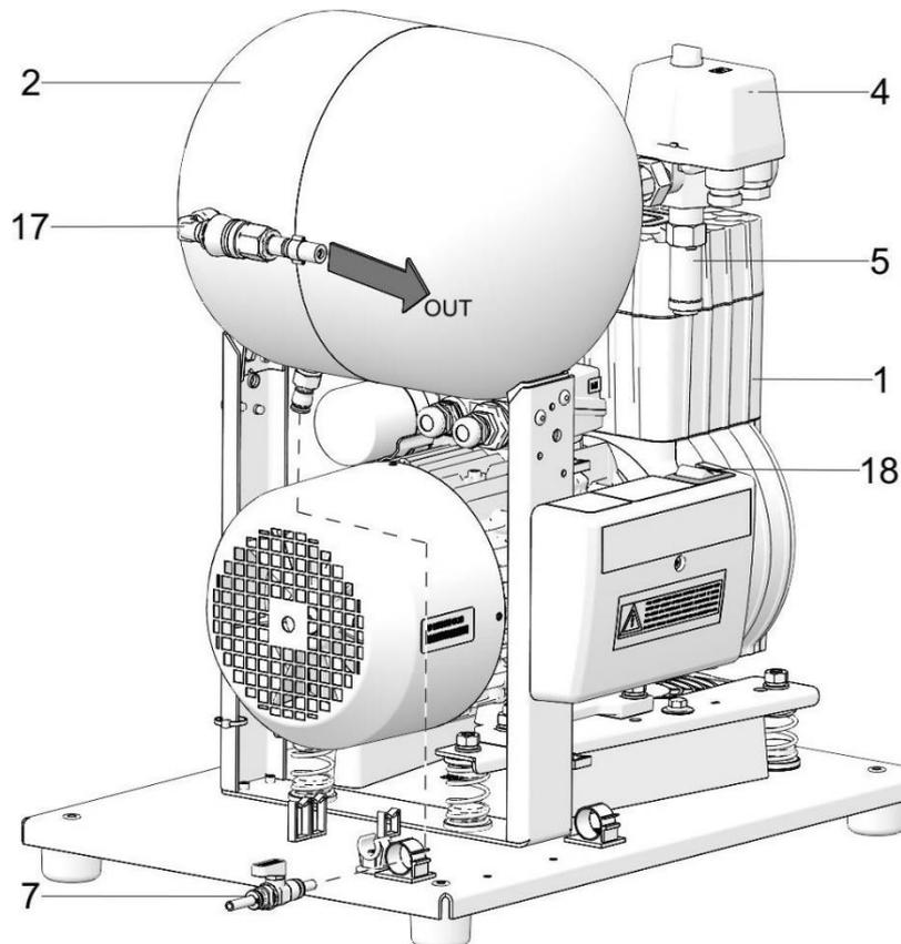
Рис. 2: DK50-10Z/M - Компрессор DK50-10Z/M с осушителем
