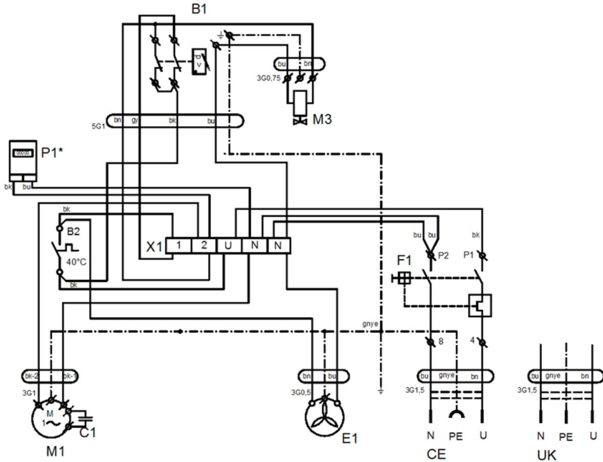
P1\* - Schließen Sie den Jumper nur für Kompressormodelle ohne Gehäuse an
