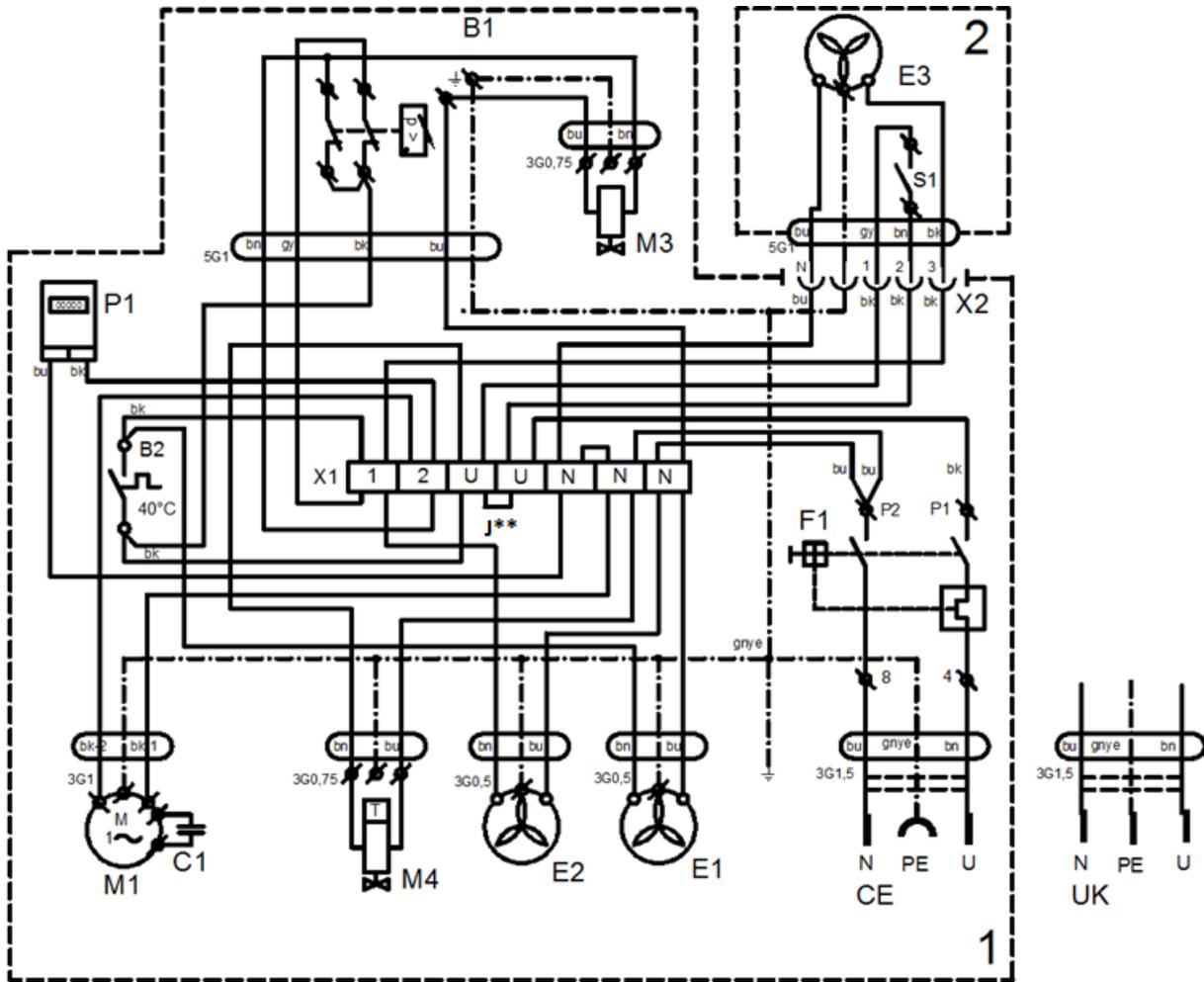
J\*\* - Stundenzähler nur für das Kompressormodell mit 8 bis 10 bar installiert (Kap. 19.10) 1-Kompressor
