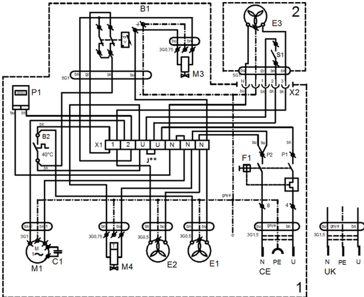
J\*\* - Connecter le cavalier uniquement pour les modèles de compresseur non installés dans des armoires (Chap. 19.10)      1- Compresseur
