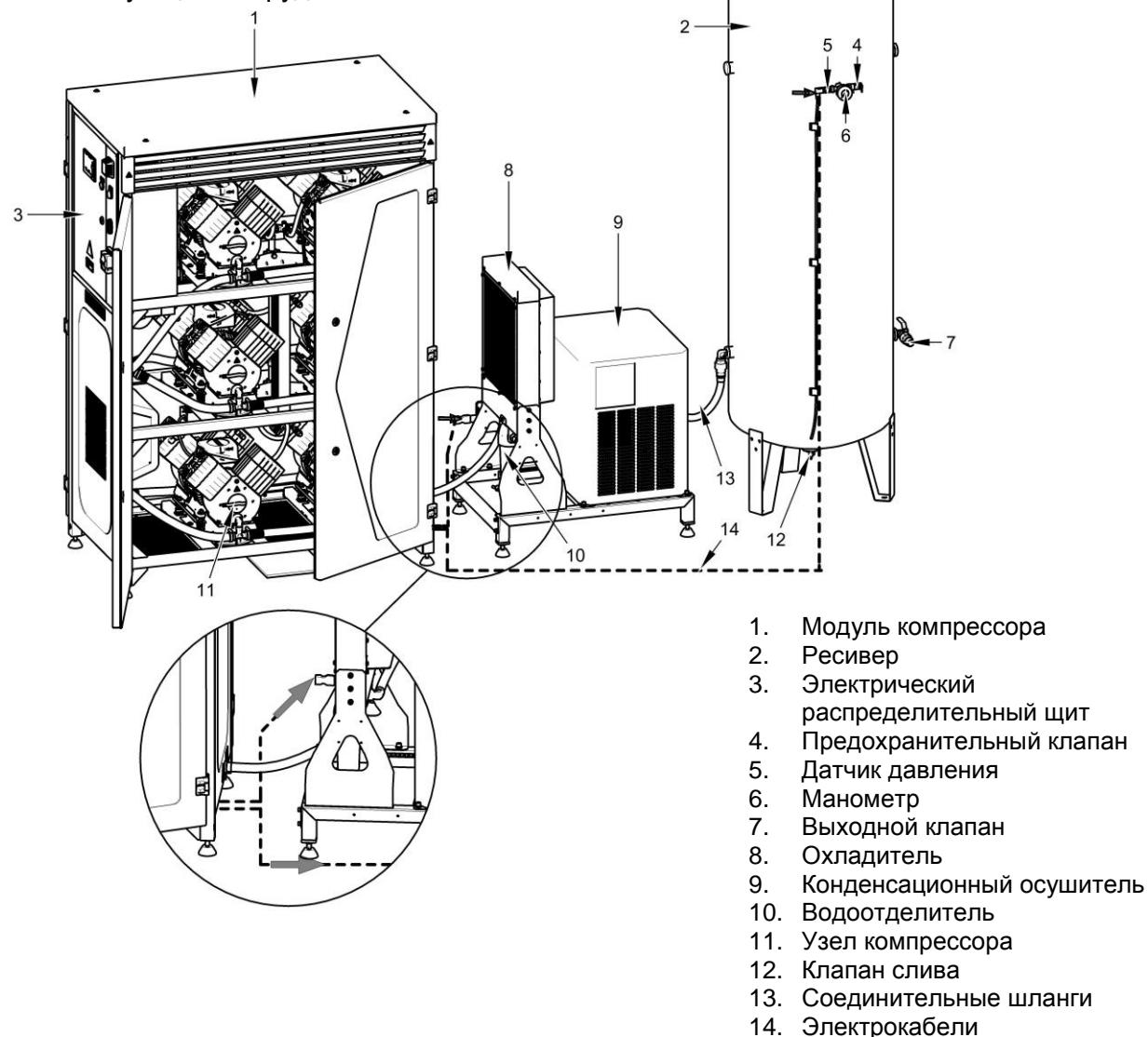
**Рис. 3. Распределительный ящик и распределительный щит**
