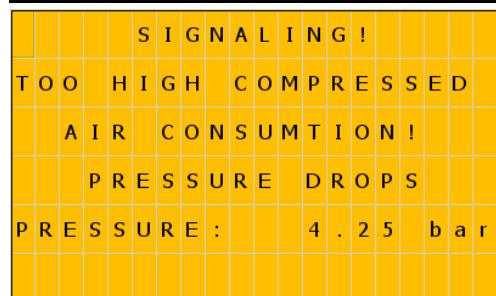
SIGNALING – сигнал о низком давлении при высоком потреблении сжатого воздуха. Дисплей начнет мигать оранжевым.
