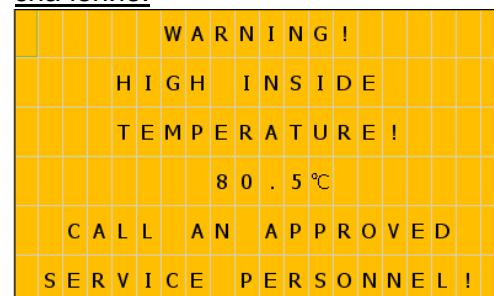
WARNING - сигнал о высокой температуре внутри компрессора с корпусом. Дисплей начнет мигать оранжевым.
