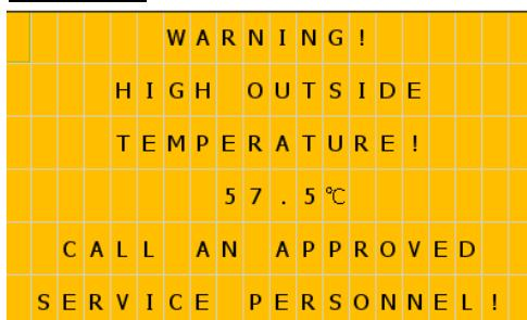
WARNING - сигнал о высокой температуре окружающего воздуха.
