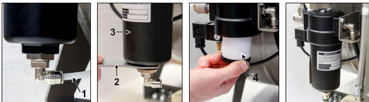
Obr. 16: Výmena filtračnej vložky vo filtri
